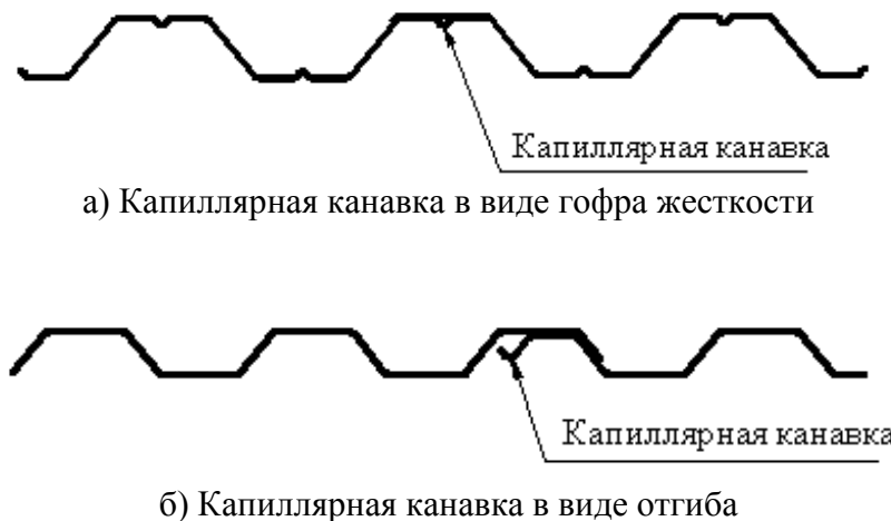
Рисунок 3 Основные виды капиллярных канавок
